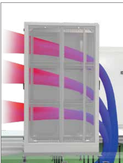
Охлажденный воздух подается из-под фальшпола в холодный коридор, горячий воздух выдувается в горячий коридор.
